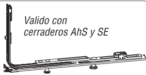
Tirante inferior 215 basculamiento inferior 180° para OB 6-32012-00-0-1
