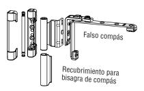
Soporte de compás Eje Recubrimiento para soporte de compás
