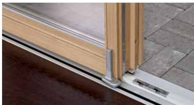
Una persona en silla de ruedas o con movilidad reducida puede atravesar la solera de forma sencilla, sin obstáculos como, por ejemplo, partes del marco que sobresalen hacia arriba para poder fijar las hojas al suelo
