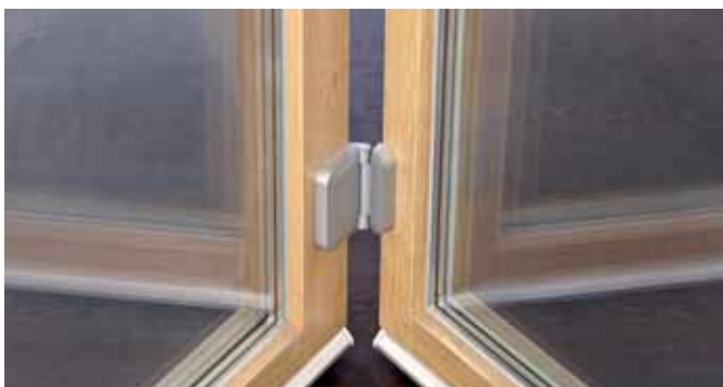
Bisagra regulable en altura, vista desde fuera; atornillamiento exterior oculto para el incremento de la resistencia a la efracción
